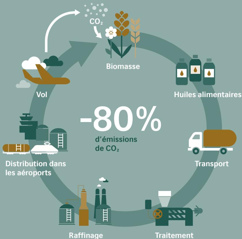
L'utilisation de Sustainable Aviation Fuel génère un cycle de CO<sub>2</sub> : le SAF est produit à partir de résidus biogènes (p.ex. huile de cuisson usagée), qui ont auparavant extrait du CO<sub>2</sub> de l'atmosphère. Lors de la combustion du SAF, la quantité de CO<sub>2</sub> émise est donc équivalente à celle qui a été extraite de l'atmosphère.
